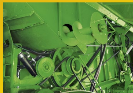
Istovarne cijevi spremnika za zrno na spremnicima za zrno manjih veličina mogu se skinuti bez alata.
