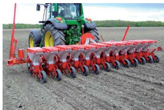
Kruti 12-oredni okvir, širine 6m, sa međurednim rastojanjem od 45cm
