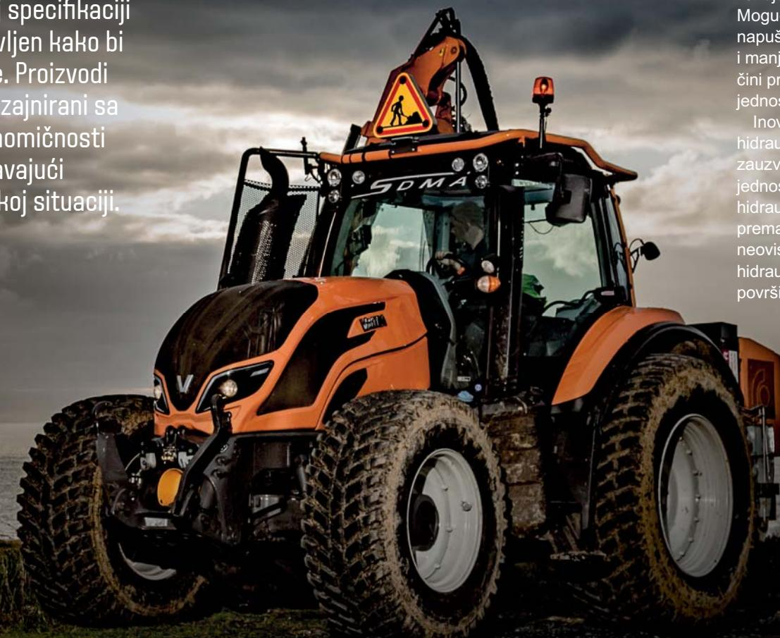
Skyview opcija krova omogućava nadmašnu vidljivost za vožnju unatrag i krovni prozor omogućava izvrsnu vidljivost za rad sa prednjim utovarivačem.
