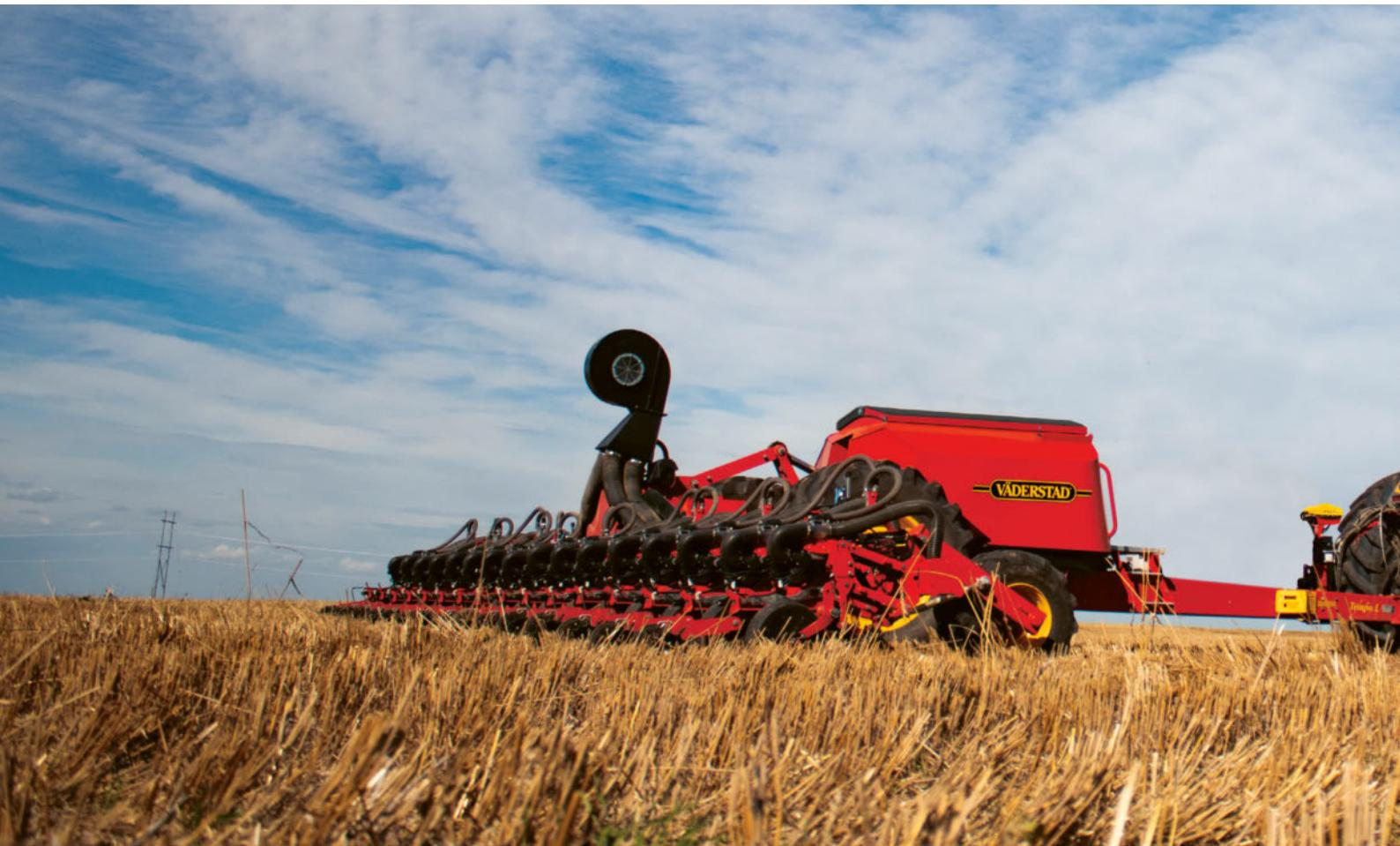
Tempo L sa Centralnim spremnikom (Central Seed Fill) je opremljen sa 3000 litarskim spremnikom za sjeme. Sistem sa Centralnim spremnikom radi kao sustav pod pritiskom, konstantno nadopunjajući visoko precizno Tempo sijaće kućište na sjetvenim redovima. Kada je sjeme dopremljeno do sijaćeg kućišta, patentirana PowerShoot tehnologija osigurava izvrsnu preciznost pri visokim brzinama kretanja.
