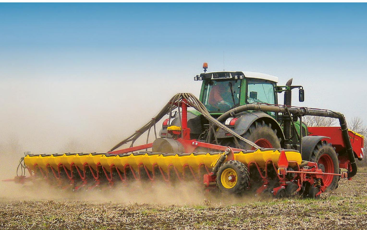
Spajanje na trotoče traktora omogućava izvrsnu upravljivost i male uvratine. Dodatno, fiksna greda donosi manje pokretnih dijelova, minimalnu težinu i smanjenu potrebu za održavanjem bez gubljenja izvrsne preciznosti koju nudi Tempo R.
