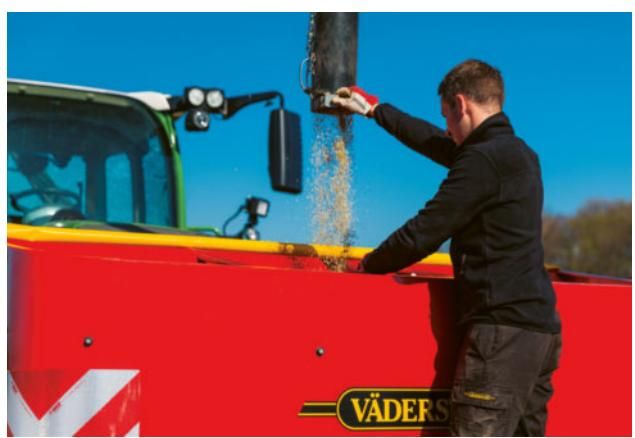
Padajući dizajn prednjeg spremnika omogućava vozaču dobru vidljivost prema naprijed. Veliki otvor sa ugrađenom stepenicom čini spremnik lakin za punjenje.
