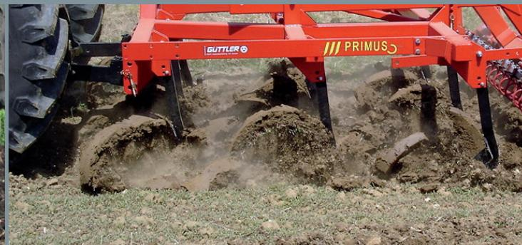
Veća radna dubina košta puno energije. Svako povećanje dubine za 1 cm znači razmrdati 150 t više zemljišta po hektaru. Obrada nastalih veleikih grudavi zahteva dalju potrebu za energijom. Zbog toga u prvom prohodu se ne preporučuje obrada na punu dubinu, pošto ovo rezultira velike, teško obradive grudve.
