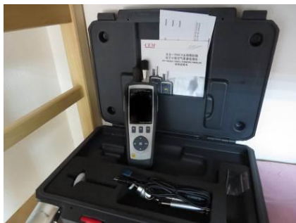
Slika 29. Aparatura za brojanje suspendovanih čestica u vazduhu, detekciju CH 2 O i CO
