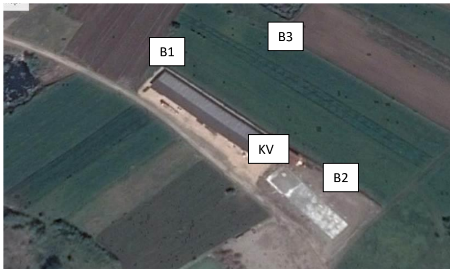
Slika 24. Indikativna mjerenja na predmetnoj lokaciji (B – mjesto mjerenja buke, KV – mjesto mjerenja kvaliteta vazduha)
