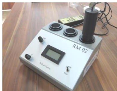
Slika 26. Reflektometar RM-02 za očitavanje zatamnjenosti filter-papira
