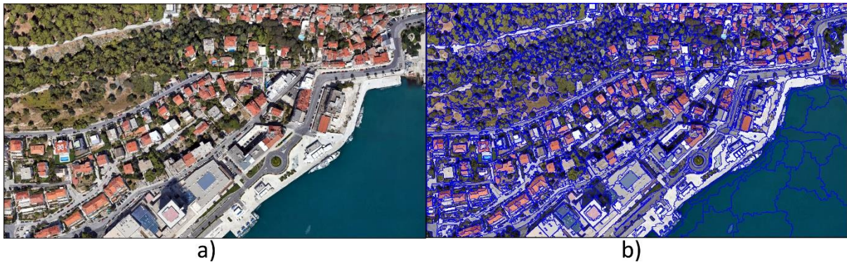
Slika 2-10 a) prikaz područja grada Splita, b) segmentirani dio područja grada Splita. Plavi poligoni označavaju segmentirane primitive/objekte.
