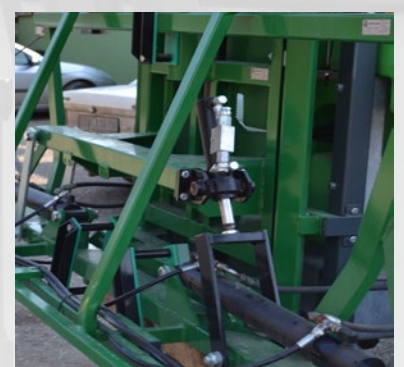
Hidraulična korekcija grana Hydraulic leveling booms
