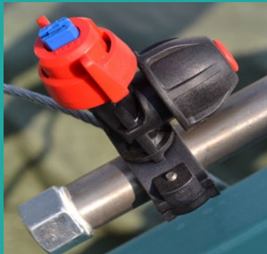
Rasprskivač sa sistemom protiv kapljenja Nozzle holder complete with nozzle and anti drop
