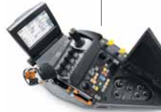
wichtige Traktorfunktionen, Multicontroller-Bedienhebel und S-Tech 300 Monitor
