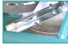
Podešavanje lopatice Adjusting the blades
