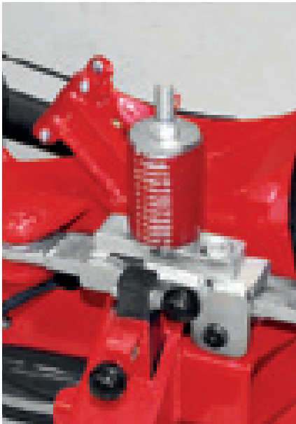
CSS - collision safety system (mehaničko osiguranje kod naleta na prepreku)
