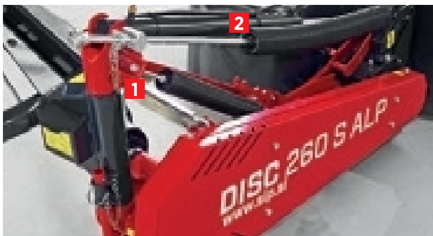
DUAL SPRING sistem rasterećenja 1. opruga za rasterećenje unutrašnje strane grebena 2. opruga podesiva u nekoliko stupnjeva za rasterećenje vanjske strane
