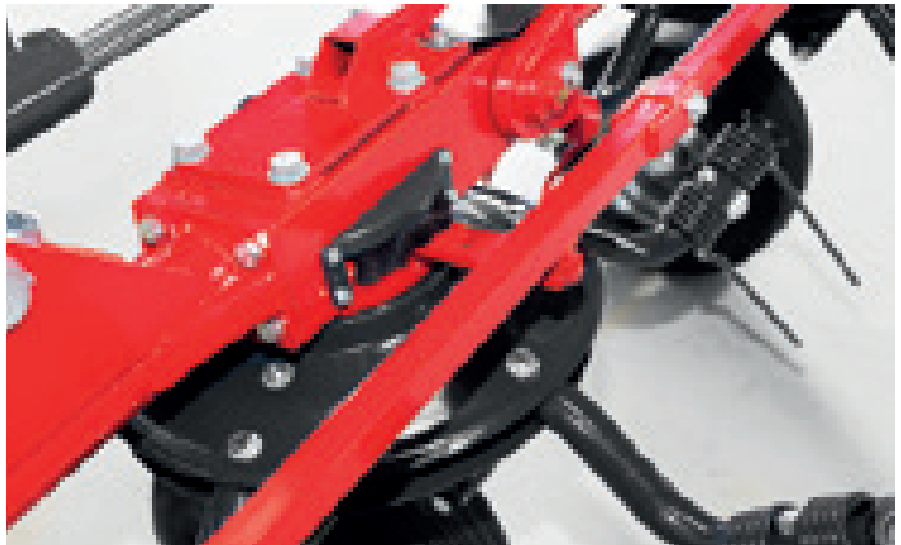
Svi modeli s oznakom "HS" opremljeni su centralnim hidrauličnim sistemom zakretanja kotača.
