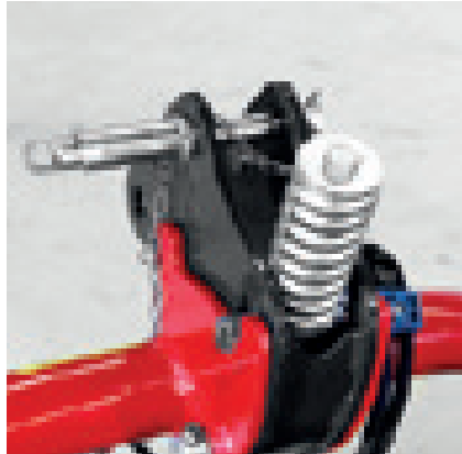
Mehanička zaštita kod naleta na prepreku
