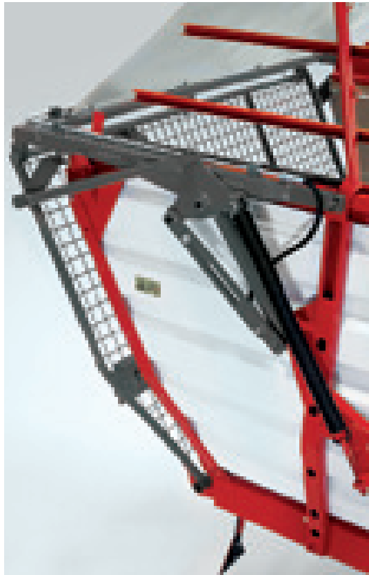
Hidraulično otvaranje zadnjih vrata
