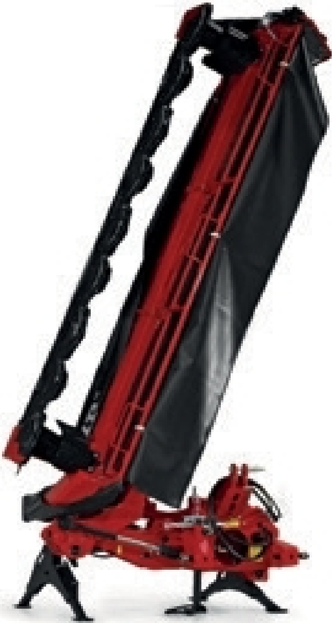
Transportni položaj grebena je 120° iza traktora. U istom položaju moguće je također skladištenje na površini svega 3,2 m 2 .
