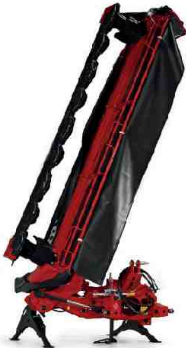
Transportni položaj grebena je 120° iza traktora. U istom položaju moguće je također skladištenje na površini svega 3,2 m 2 .
