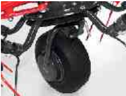
Kotači s mogućnošću podešavanja visine i podešavanjem kuta rastresanja. Mogućnost zakretanja kotača za rastresanje uz među.
