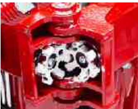
Pregibna prstasta spojka omogućava miran rad i prijenos velike snage.
