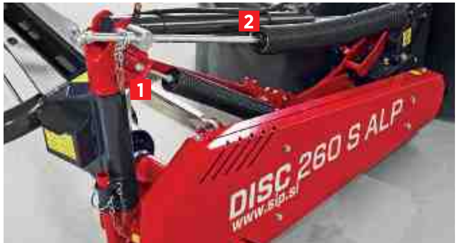
DUAL SPRING sistem rasterećenja 1. opruga za rasterećenje unutrašnje strane grebena 2. opruga podesiva u nekoliko stupnjeva za rasterećenje vanjske strane
