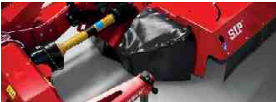
Izravni pogon preko kardanske osovine s kliznom sklopkom. Pogon gnječilice preko posebnog nazubljenog remena (Gates), koji ne zahtjeva dodatno natezanje.
