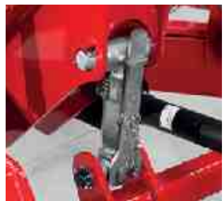
Patentirano podešavanje kuta rotora - mogućnost hidrauličnog podešavanja
