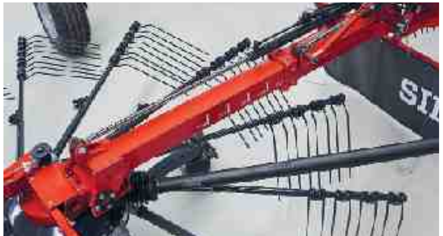
Kontinuirano hidraulično podešavanje širine sakupljača i tokom rada kod modela STAR 850|26 T
