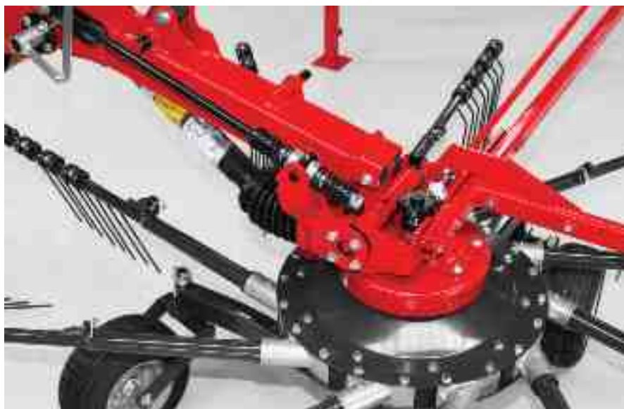
Modularni rotor s 3D priključenjem za bolju prilagodbu
