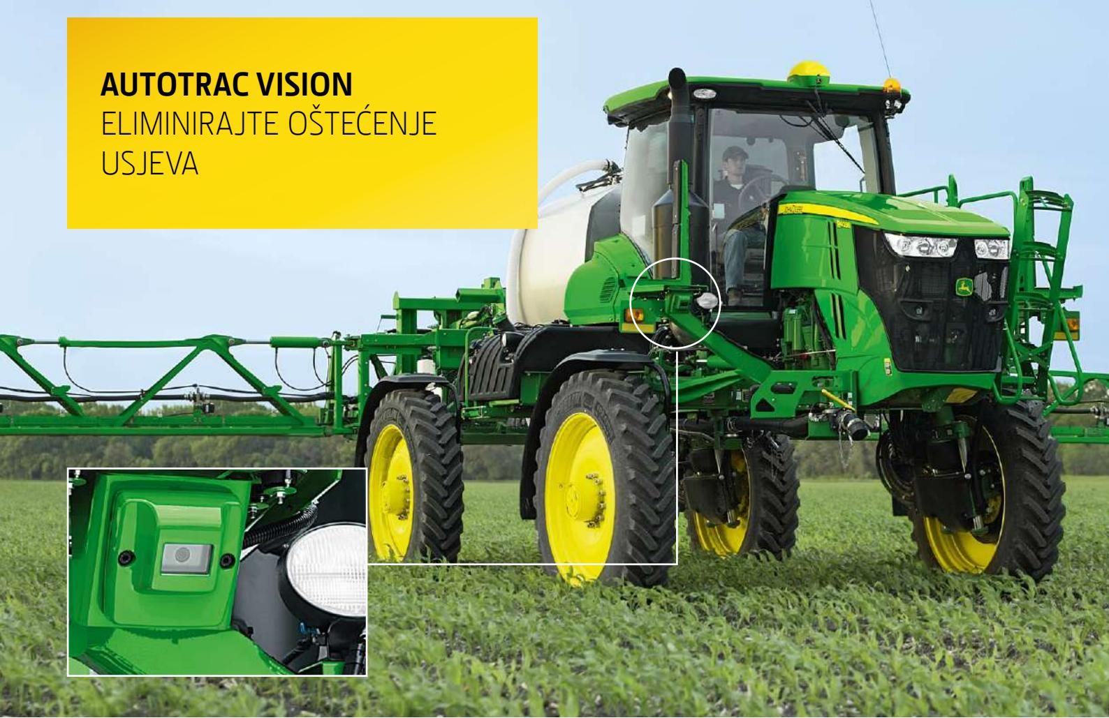
AutoTrac Vision\* koristi kameru montiranu sprijeda da se uoči ranosezonski kukuruz, sojine sjemenke i pamuk visine od barem 10 do 15 cm. Sustav navođenja održava kotače prskalice u sredini svakog retka i smanjuje štetu usjeva koja utječe na prinos, čak i ako odstupanje sijačice uzrokuje nepodudarnosti ili crta navođenja od sijanja nije dostupna kod prskanja.
