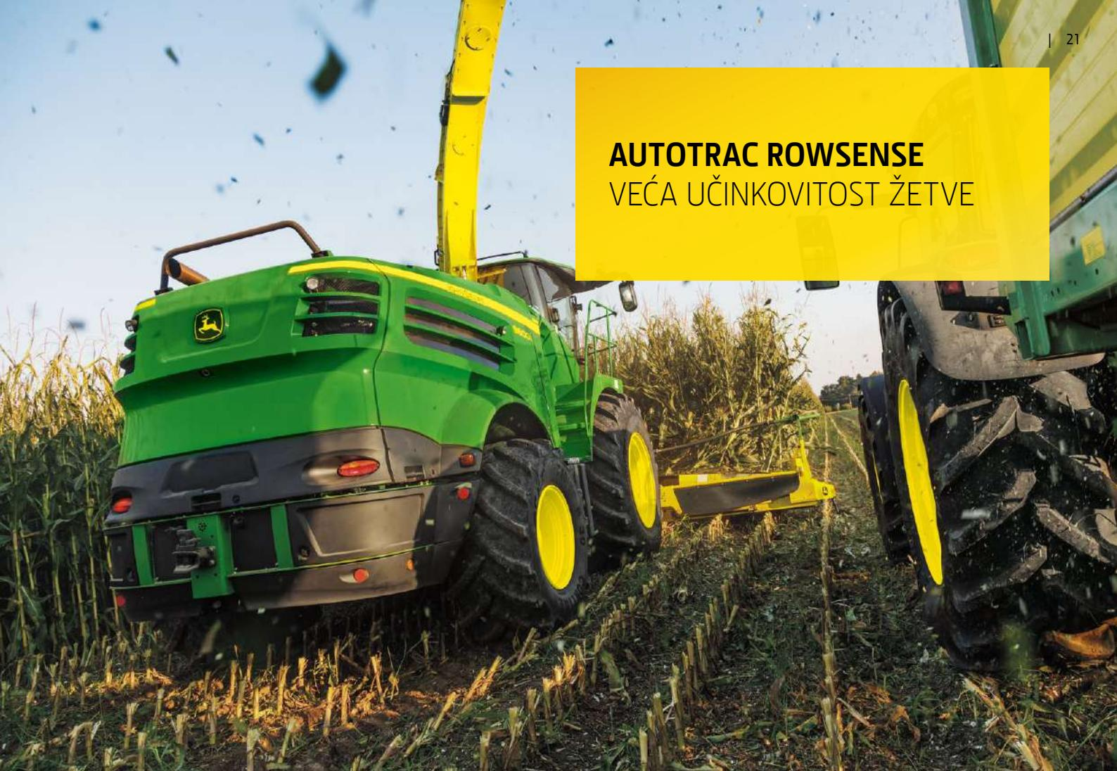
Bilo da je riječ o oborenom kukuruzu, krivuljama ili jednostavno žetvi u polju s neravnomjernim razmakom redova, jer je sijano bez sustava AutoTrac: AutoTrac RowSense pomaže da uvijek ostanete u pravom redu, omogućujući vam da se koncentrirate na stroj, zadržavajući brzinu te značajno smanjujući stres vozača.
