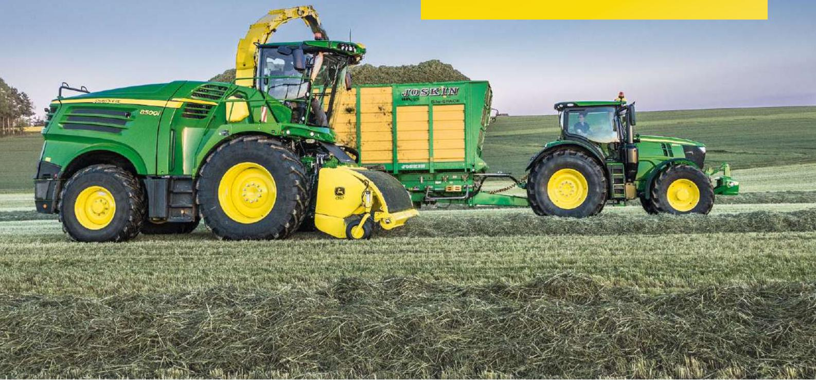
Vлага u usjevu može varirati do 20% u jednom polju što zahtijeva različitu dužinu rezanja radi osiguravanja idealnog zbijanja silaže bez uključaka kisika. Opremljen na John Deere silažnim kombajnima, HarvestLab 3000 omogućuje namještanje automatske dužine reza na temelju koncentracije suhe tvari. Automatsko namještanje omjera cjepiva silaže pomaže u optimizaciji fermentacije i može uštedjeti do 10% silažnih aditiva.
