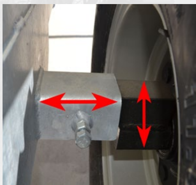
Osovina podesiva po širini i visini Width & height adjustable axle
