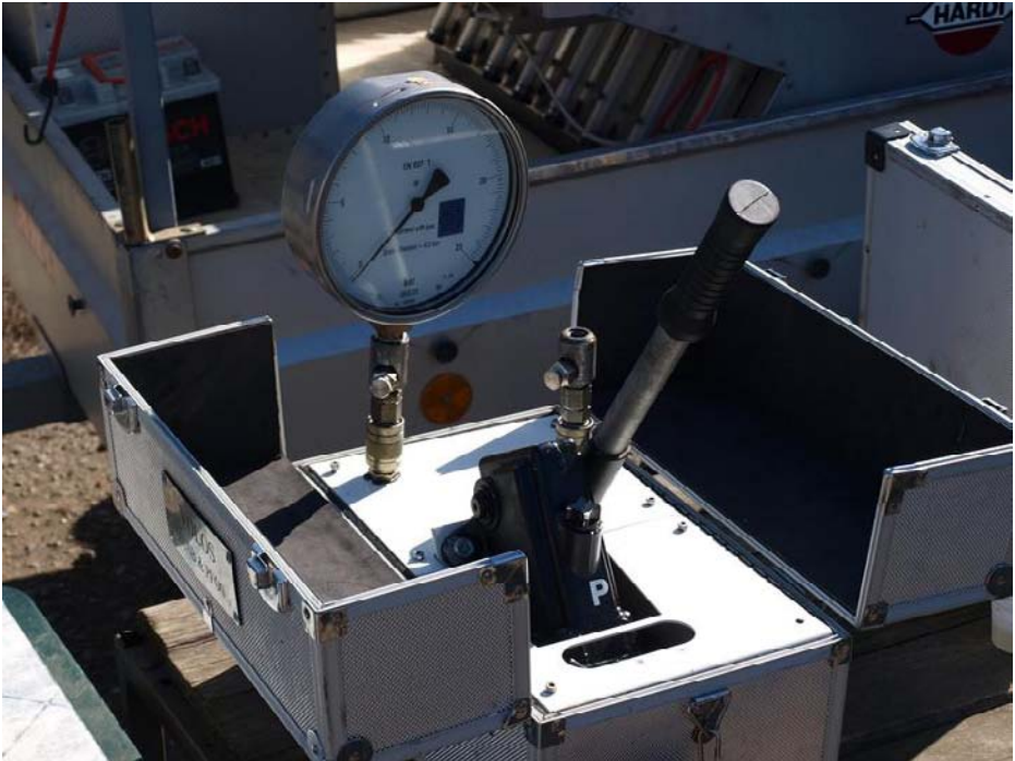
Uređaj za ispitivanje ispravnosti manometra „Volos“
