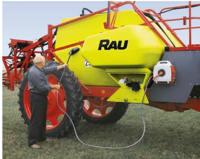
Slika 13.33: Pranje prskalice izvana na površini gdje je obavljeno tretiranje (Izvor: Unapređenje tehnike aplikacije pesticida, Đ. Banaj)
