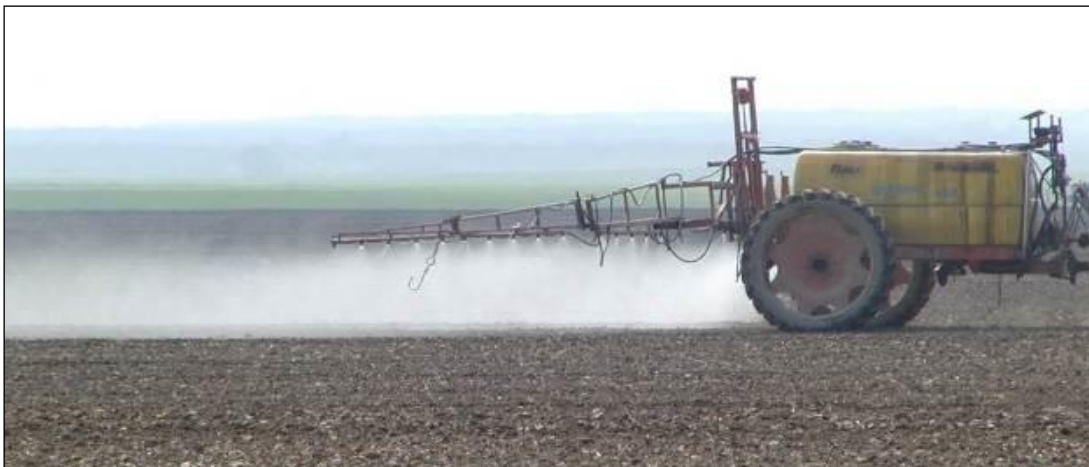
Slika 13.22: Zanošenje, tj. odnošenje kapljica tijekom rada prskalice (Izvor: Unapređenje tehnike aplikacije pesticida, Đ. Banaj)
