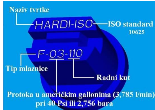
Slika 13.10: Oznake na sapnici ratarske prskalice (izvor: Unapređenje tehnike aplikacije pesticida, Đ. Banaj)
