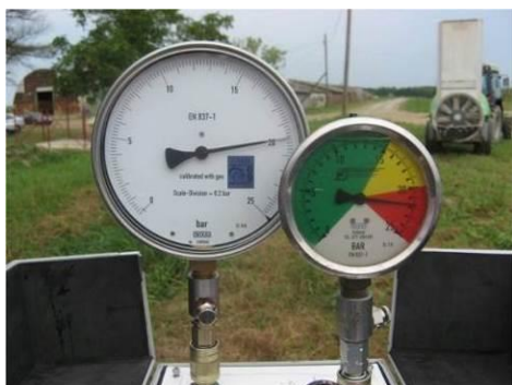
Slika 13.1: Kontrola ispravnosti manometra (izvor: www.amazone.com )
