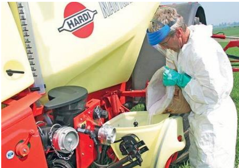
Slika 13.16: Punjenje spremnika stroja za primjenu korištenjem osobne zaštitne opreme (izvor: www.hardi-international.com )
