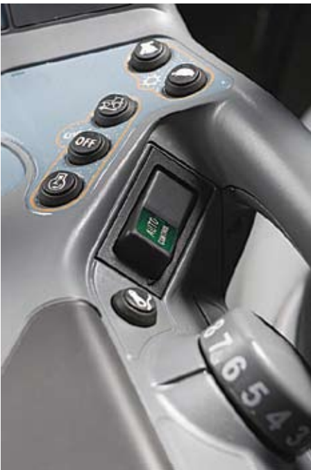
Većina funkcija vanjske hidraulike može se aktivirati koristeći joystick, prekidače i tastere
