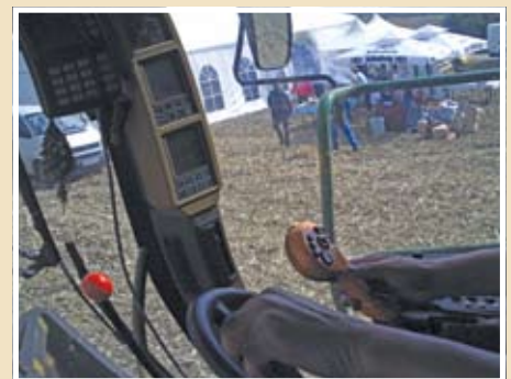
Višenamjenska kontrolna ručica na dohvata ruke integrira najčešće korištene funkcije u jedno mjesto te umanjuje stres i zamor
