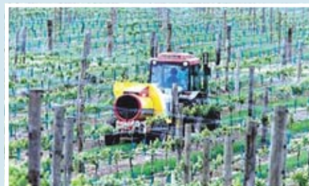
Razmak između prohoda strojem ne smije biti veći od 140 metara, on je obično 70-60 metara
