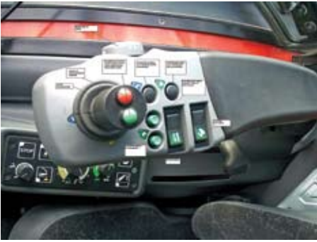
Većina funkcija vanjske hidraulike može se aktivirati koristeći joystick, prekidače i tastere
