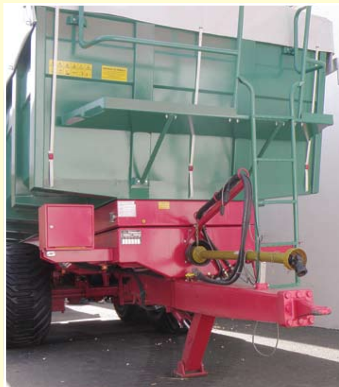
Kardansko vratilo za upravljanje operacijama na istovaru i slično
