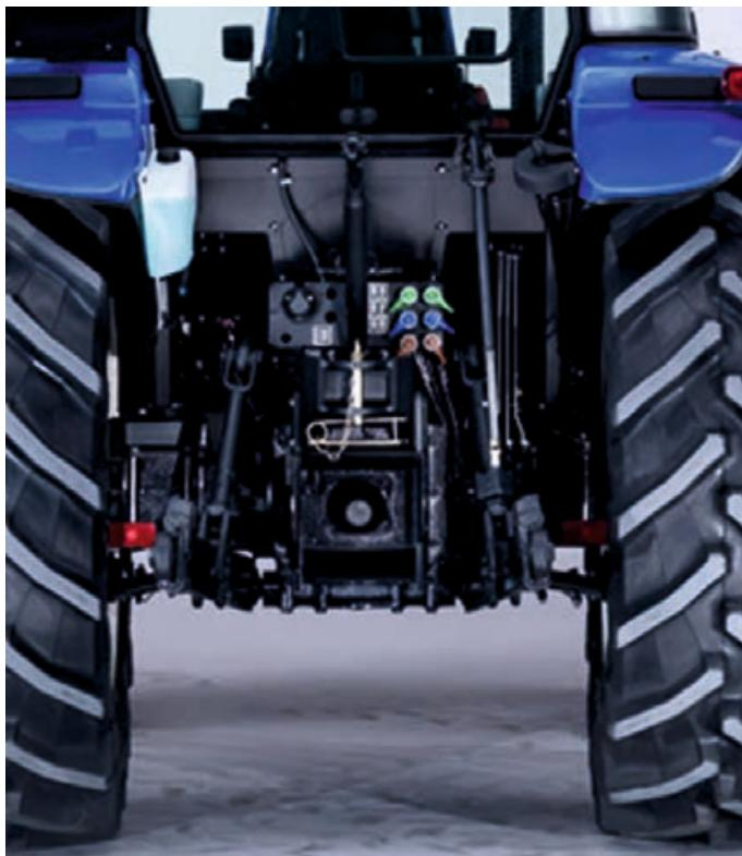
Stražnje podizne poluge imaju podiznu moć od 3000 kg kod modela TD5010, TD5020 dok kod modela TD5030, TD5040, TD5050 podizna moć iznosi 3565 kg.
