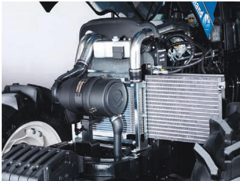
Jedna od karakteristika New Hollandovih odnosno Ivecovih motora je „CrossFlow”; to je motor kod kojeg hladni usisni zrak iz intercoolera dolazi s jedne strane a ispušni plinovi izlaze na drugu stranu tj. nema preklapanja usisnog voda s ispušnim vodom pri čemu je dolazilo do zagrijavanja hladnog zraka koji je ulazio u cilindar s vrućim ispušnim plinovima koji su izlazili iz cilindra.
