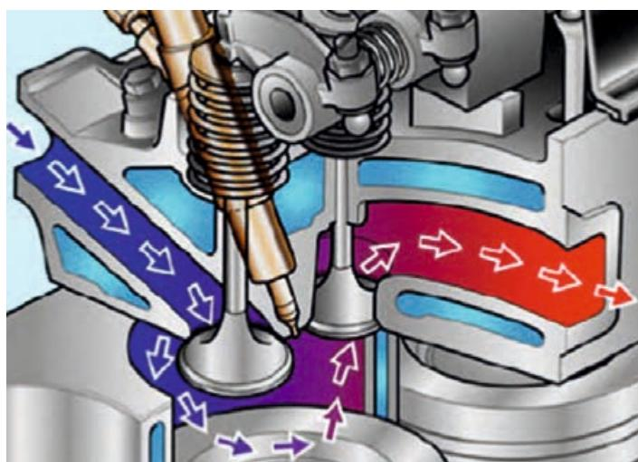
S ovim sustavom dobave hladnog zraka s jedne strane i odvođenjem vrućih ispušnih plinova s druge strane, dobilo se više snage iz motora uz smanjenje emisije štetnih plinova i potrošnje goriva.
