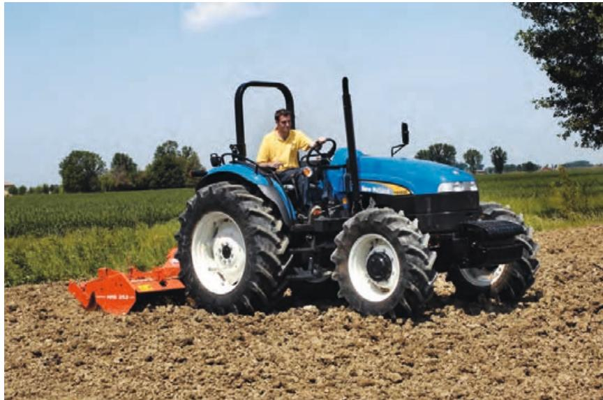
Pogon na sva četiri kotača te blokada diferencijala uključuje se mehanički kod standardno opremljenog traktora dok se kao opcija nudi i elektrohidrauličko uključivanje preko prekidača na kontrolnoj ploči
