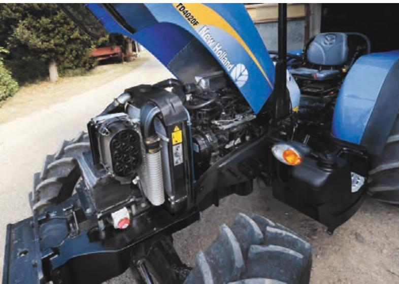
U traktore serije TD4000F ugrađeni su New Holland F5C motori dobro poznati motori iz serije T4000 V/N/F, koji zadovoljavaju eko norme Tier III. Svi motori imaju zapreminu 3200 cm<sup>3</sup> te turbopunjač i hladnjak usisnog zraka (intercooler) sa rasponom snage od 65-88 KS. Spremnik goriva ima kapacitet 80 litara i omogućuje nesmetan rad tijekom cijelog dana.
