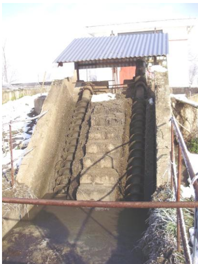
17. Pužni transporter za izvlačenje stajnjaka Namjenjeni su za grubo odvajanje grube i tečne faze stajnjaka
