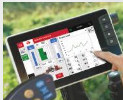
I preša RB i kombinirane verzije preše/omotača RB Protec mogu se specificirati ISOBUS spojem za upotrebu ekrana traktora.
