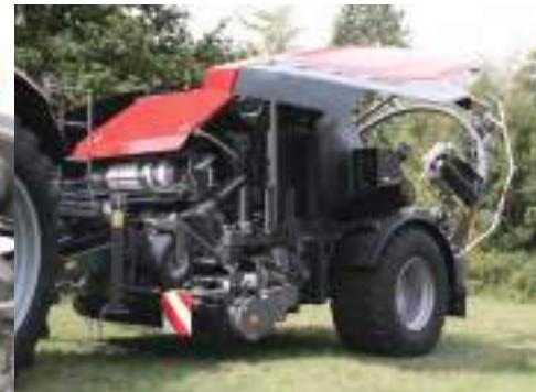
Dvanaest držaća kotača prigodno je smješteno na primjerenoj visini s obje strane balirke, a zahvaljujući dvama dodatnim kotačima ugradenima u omotač povećavaju vrijeme rada u polju.
