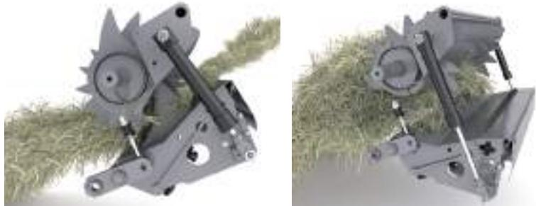
U slučaju začepljenja rukovatelj lako može otvoriti pod postolja utovarivača i istovremeno spustiti noževe kako bi omogućio dovoljno prostora za prolaz materijala.
