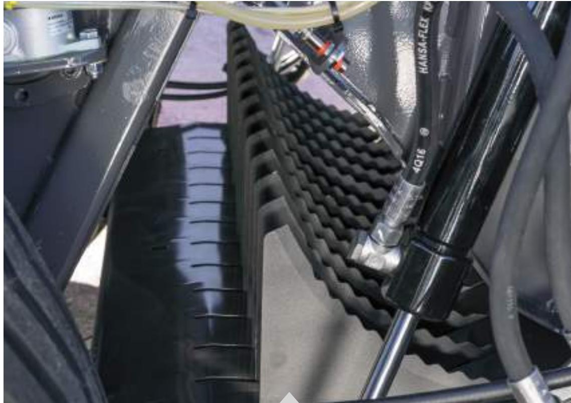
Model MF RB 3130F može biti opremljen rezačem **Xtracut** s 13, 17 ili 25 noževa.
