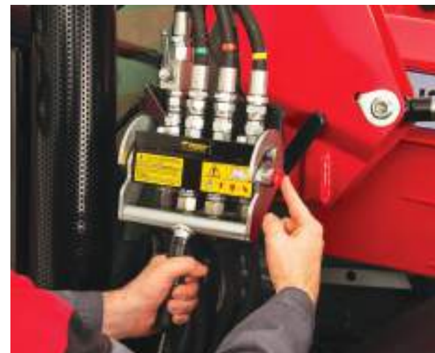
Odspojite hidrauličke i elektroničke spojeve
