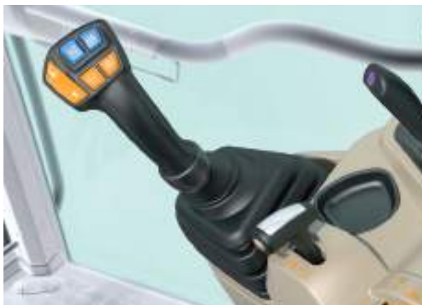
Opcija kabine Essential s mehaničkim multifunkcionalnim joystickom
