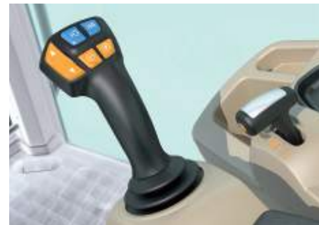
Opcija kabine MF 5700 S Essential s elektroničkim multifunkcionalnim joystickom za utovarivač
