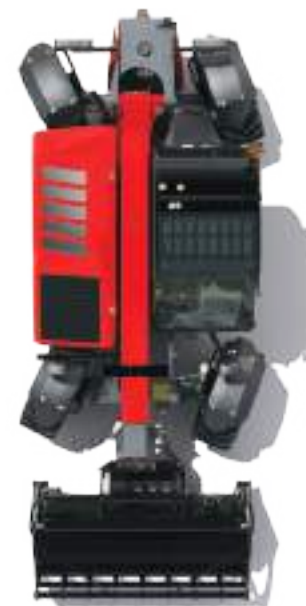
Način upravljanja četirima kotačima
