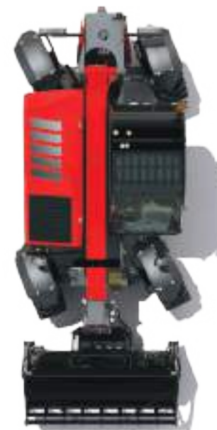
Način dijagonalnog upravljanja
