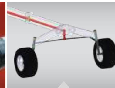
Polu-osovine kakve se koriste kod komercijalnih vozila
