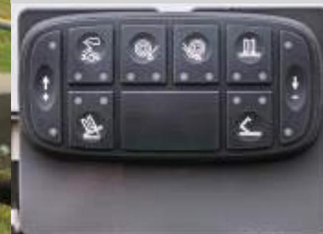
Vanjska nadzorna ploča sa strane balirke omogućava kontrolu stražnjih vrata, prstena omotača, podloge i hvataljki omota za jednostavnu promjenu omota, održavanje ili čišćenje.
