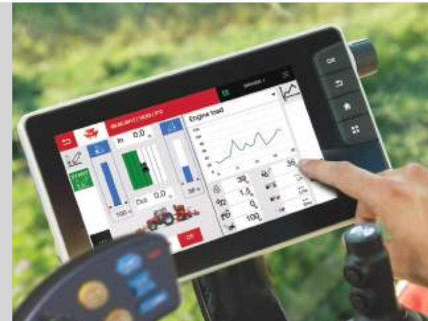
Preša MF 4160V Protec može se specificirati s ISOBUS spojem za upotrebu ekrana traktora. Upotreba jedinstvenog terminala u kabini traktora za sve priključke smanjuje prenatašpanost kabine i doprinosi jednostavnijoj i točnijoj kontroli vozača koji različitim strojevima mogu izvršavati širok raspon radnji.
