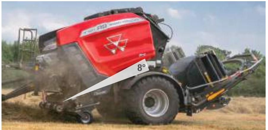
Nova kombinirana jedinica Protec ima niži kut podizanja usjeva, što smanjuje ukupnu visinu preše. To svojstvo poboljšava stabilnost, omogućujući sigurniji i brži rad na uzbrdici. Smanjuje i povratni tlak u prostoru za utovar, usmjeravajući protok usjeva i smanjujući rizik od začepljenja.
