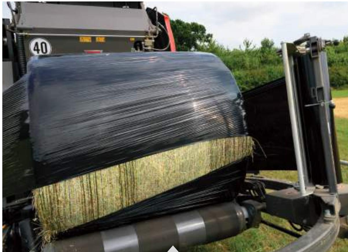
Hidraulički pogon podloge omotača sastoji se od dvaju kotača i triju beskrajnih remena ugrađenih na zavareni okvir radi dodatne izdržljivosti. Osjetnik ispod srednjeg remena omogućit će početak omatanja tek nakon što se bala do kraja postavi na podlogu, dok četiri velika bočna kotača balu tijekom omatanja drže u sredini.
