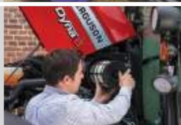
Kompaktna rashladna jedinica osigurava odličnu vidljivost preko tankog, uskog poklopca motora, dok i dalje daje dosta prostora za cirkulaciju svježeg zraka, čišćenje i servisiranje.
