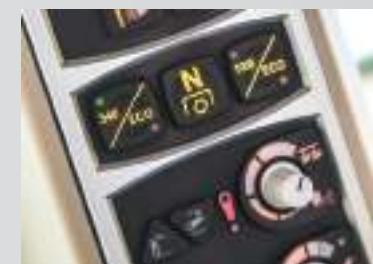
Elektrohidraulični izbor brzine priključnog vratila
