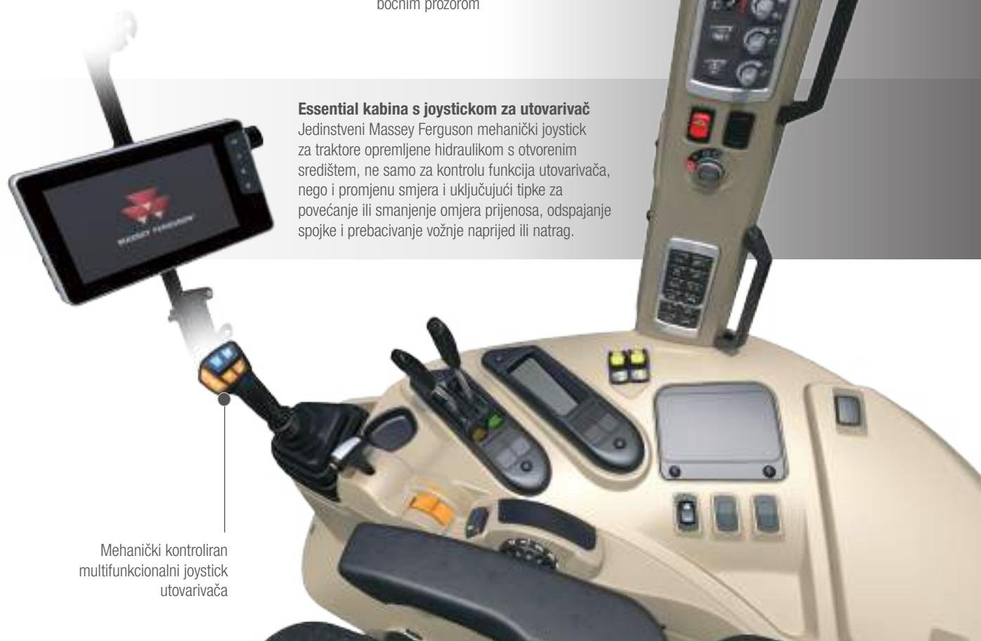
**Essential kabina s joystickom za utovarivač**
