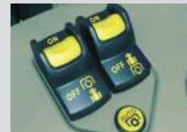
Kontrola rukovatelja dolazi iz prekidača montiranog na desnoj konzoli
