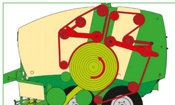
Varijabilna komora za bale (V 1500 i V 1800): dva beskonačna lančana šipkasti elevatora oblikuju izuzetno zbijene bale.
