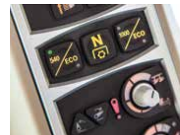
Električno-hidraulički odabir brzine vrtnje kardanskog vratila
