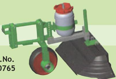
Trama i Tramus modeli su opremljeni pumpom pokretanom kotačem tako je doziranje ovisno o pređenom putu a ne o brzini kretanja unaprijed. Dizne su pokretane punjivom baterijom ili spojem na ploču vozila. Zglobni paralelogram osigurava da se kontakt kotača s površinom ne gubi tako da se rad pumpe ne prekida. Zaslon za raspršivanje se može prilagoditi od 70 do 110 cm na obje jedinice.
