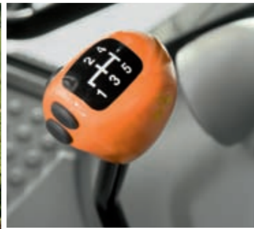
Die Lastschaltstufen werden bequem über Taster im Schaltknopf gewechselt.
