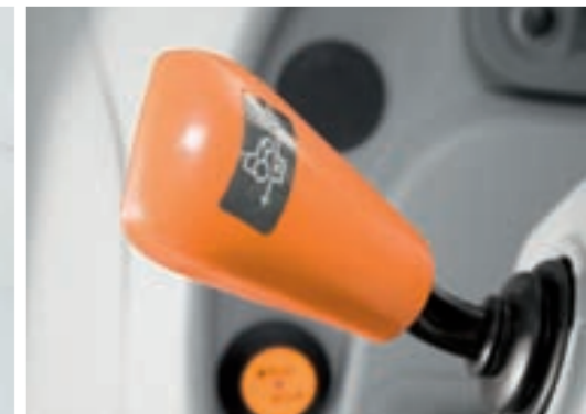
Powershuttle auf Wunsch: Wechsel der Fahrtrichtung einfach und bequem.
