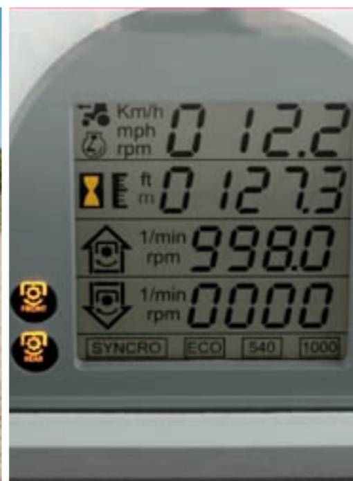
Die aktivierte Zapfwellengeschwindigkeit wird im Display angezeigt.
