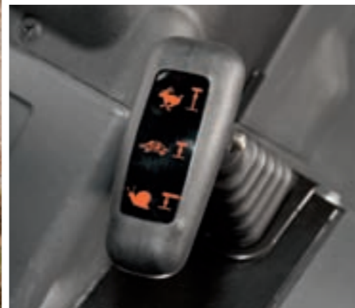
Drei Gruppen stehen für bis zu 45 verschiedene Arbeitsgeschwindigkeiten zur Verfügung.
