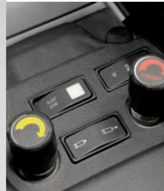
Elektro-hydraulische Seitenstabilisierung und Durchflussmengeneinstellung für Zusatzgeräte.
