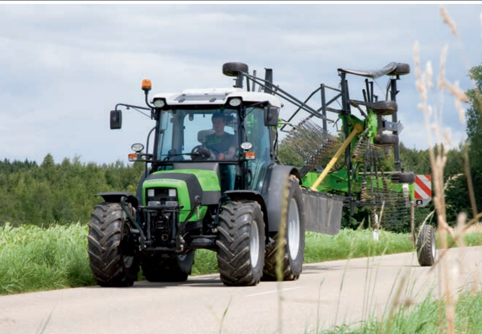
Verstellbare Kotflügel sind serienmäßig und verringern den Wenderadius.
