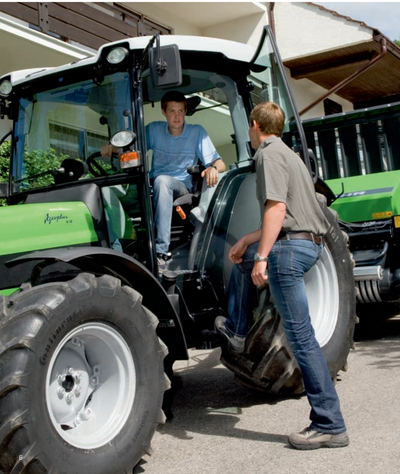
Dank der neuen 4-Pfosten-Kabine genießt der Fahrer eine hervorragende Rundumsicht.
