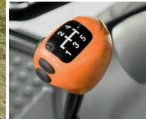
Leichtes Wechseln der Lastschaltstufen im Schaltknopf.
