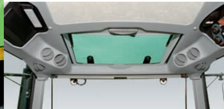
Bei Frontladerarbeiten ist der Frontlader durch das Freisichtdach bestens zu sehen.
