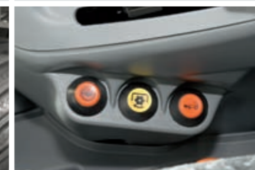
Die Differenzialsperren sind per Knopfdruck schaltbar.
