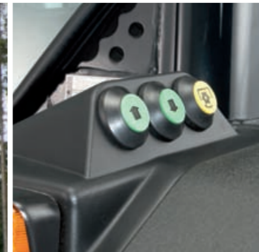
Sicher im Blick und im Griff: Die Heckbetätigung des Heckkrafthebers.
