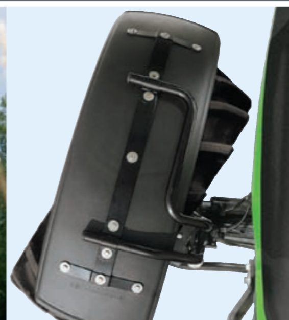
Verstellbare Kotflügel sind serienmäßig und verringern den Wenderadius.
