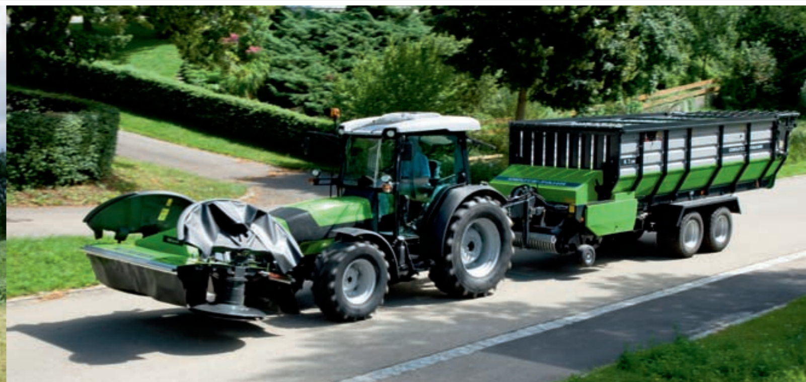
In Kombination mit einem DEUTZ-FAHR Niederflur-Ladewagen passt der Agroplus dank seiner minimalen Aussenhöhe von nur 2,38 m (je nach Modell und Bereifung) auch durch niedrige Stalleinfahrten.
