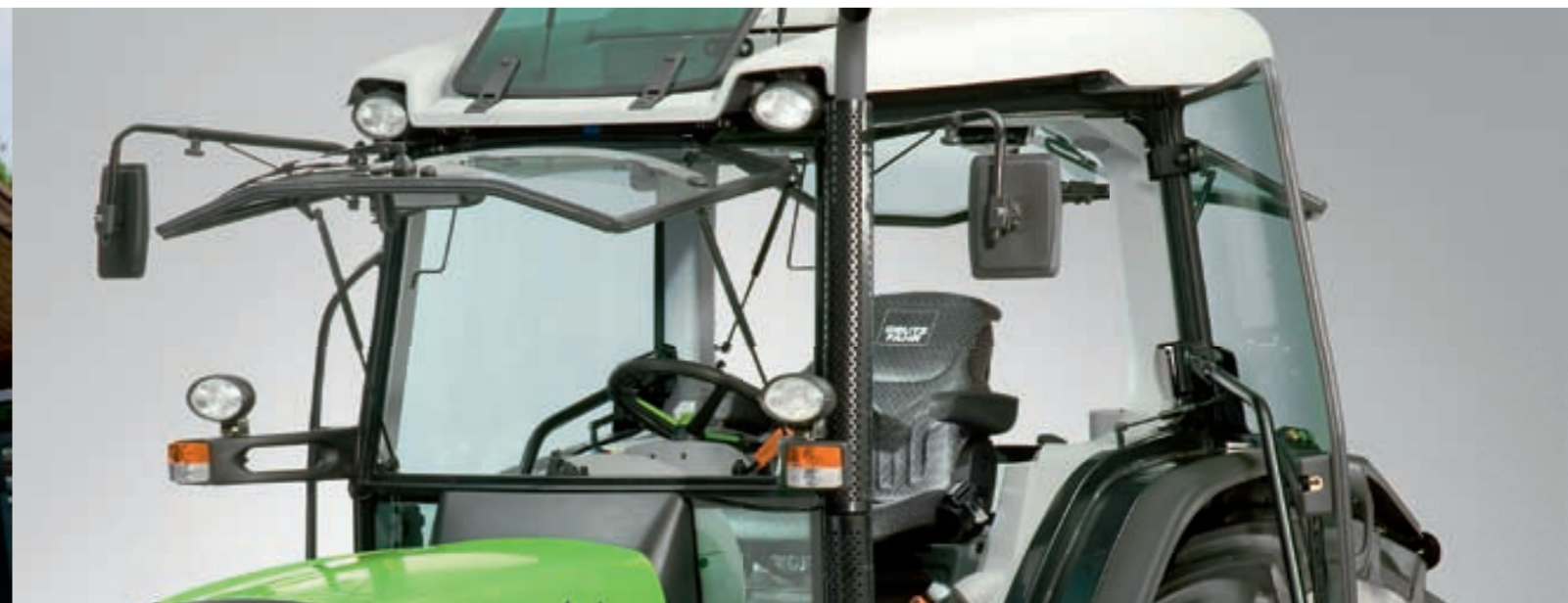
Dank der neuen 4-Pfosten-Kabine genießt der Fahrer eine hervorragende Rundumsicht.
