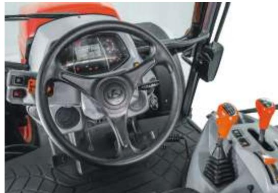
Upravljač se pomiče unaprijed ukoliko postoji potreba za još više mesta prilikom izlaska, a jednostavno se vraća u poziciju. Kut upravljača omogućuje kompletan uvid u kontrolnu ploču.
