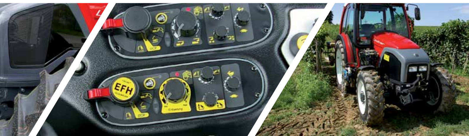
EFH - elektronische Fronthubwerksregelung mit Schwingungstilgung
