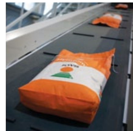
Upakovane vreće se transportuju do automatizovanog uređaja koji ih slaže na paletu po unapred definisanom rasporedu i umotava ih u PVC foliju radi zaštite pri skladištenju i isporuci krajnjim korisnicima.
