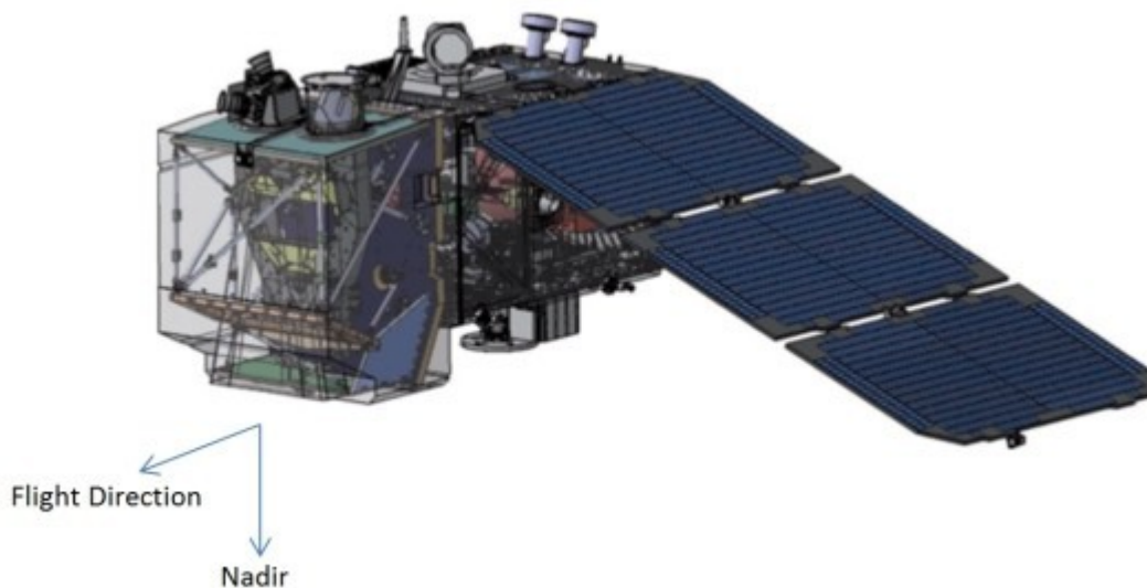
Na sebi nose optičko-elektronski senzore (MSI) (Izvor: Copernicus)
