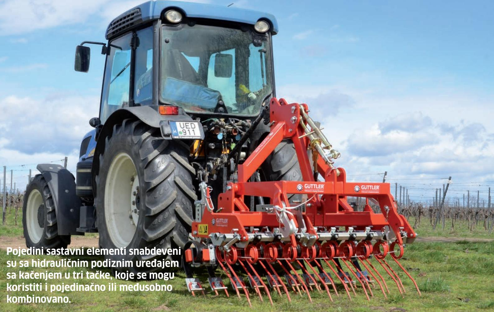
Pojedini sastavni elementi snabdeveni su sa hidrauličnim podiznim uređajem sa kačenjem u tri tačke, koje se mogu koristiti i pojedinačno ili međusobno kombinovano.
