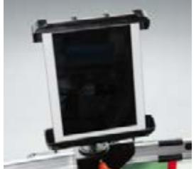
Nosač dodatne opreme na desnoj strani kabine omoguće jednostavan i vizualno optimiziran raspored dodatnih priključaka.
