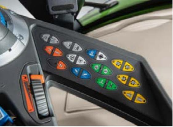
Sve funkcije su jednostavno i jasno raspoređene na membranskoj tipkovnici s pozadinskim osvjetljenjem u skladu s dokazanom Fendtovom logikom rada.
