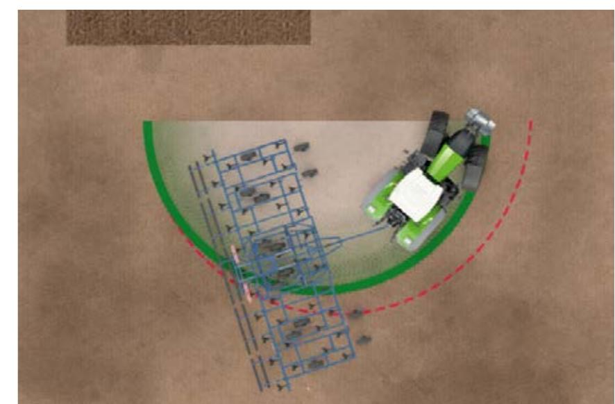
Polumjer malog traga efektom "pull-in-turn", npr. 6,1 m kod Fendt 930 Vario sa standardnim gumama.
