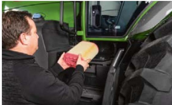
Filter kabine je lako dostupan u ulaznom prostoru i kabina se može lako očistiti, ako je to potrebno.
