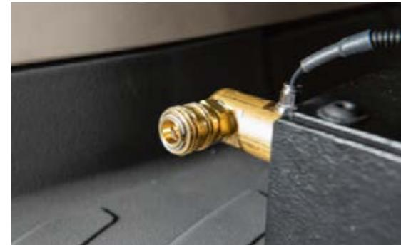
Kabina se može brzo očistiti zahvaljujući praktičnom priključku za crijevo s komprimiranim zrakom.
