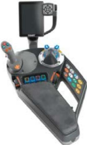
Profesionalna upravljačka poluga ima četiri gumba za upravljanje Variotronic™-om, dva sustava tempomata, dvije jedinice za pohranu broja okretaja motora i gume za upravljanje dvama hidrauličkim ventilima. Varioterminal 10.4" ima dva ulaza kamere.
