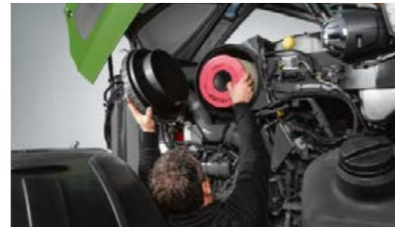
Stupanj onečišćenja filtra zraka prikazan je u Varioterminalu. Odjeljak motora je posebno pristupačan preko bočnih dijelova koje je moguće ukloniti.
