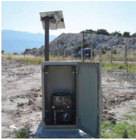
Lacme električni pastir u zaštitnoj kutiji. Napajanje je preko solarnog panela.
