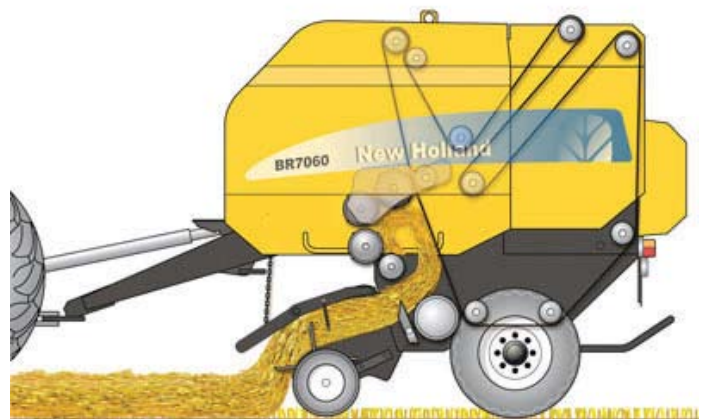
Shema nastajanja bale u komori
