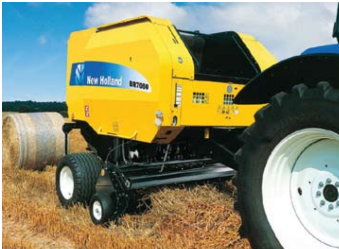
BR7060 - Bilo da se radi o sijenu, slami ili silaži, kombinacijom valjaka i hrapavog remena stvaraju se najbolje bale, savršenog oblika i čistog završetka
