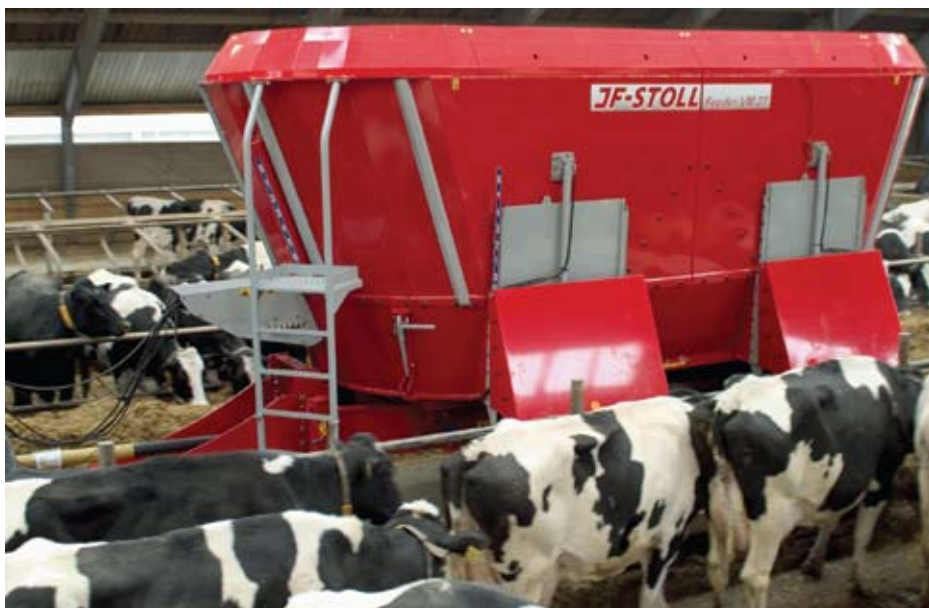
Na slici je VM-27 koji ima po dva otvora za istovar obroka sa svake strane
