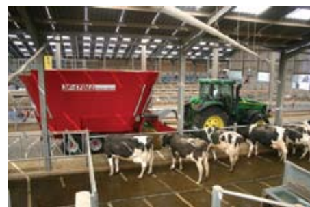
Na ovoj mikserici istovar je na prednjem dijelu
