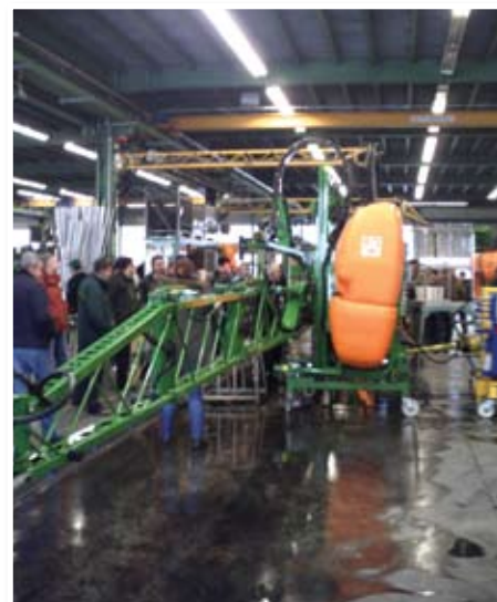
Dio pogona u Osnabrucku u kojem se ispituju završene prskalice
