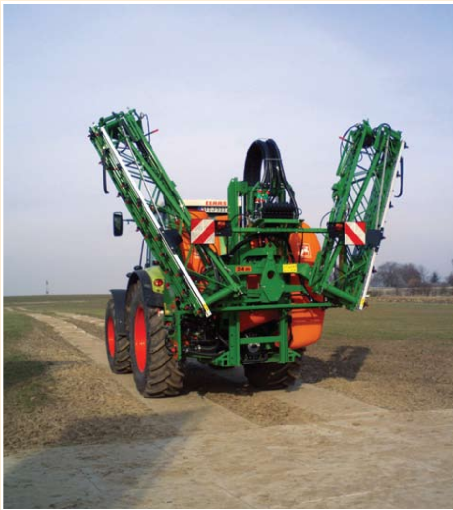
Nošena UX prskalica na poligonu prigodom raširivanja krila raspona 24 metra
