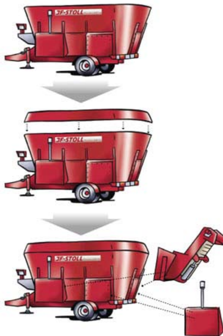
Na ovom shematskom prikazu vidljiva je mogućnost modularnog proširivanja prikolice i izmjene otovra za istovar hrane
