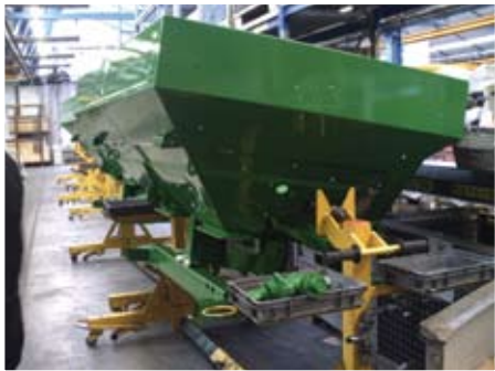
Zaštita je bojanjem KTL kao u auto industriji, što znači da se boja dva puta peče
