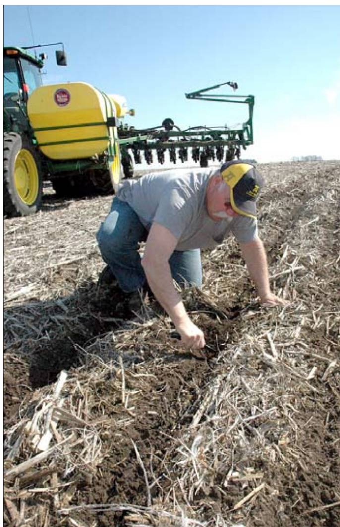
Sijačice moraju biti dobro podešene kako bi sjeme bilo na pravoj dubini.
