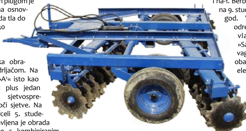
Tlo je u dva prohoda obrađeno tanjuračom Drava osječčkog proizvođača OLT
