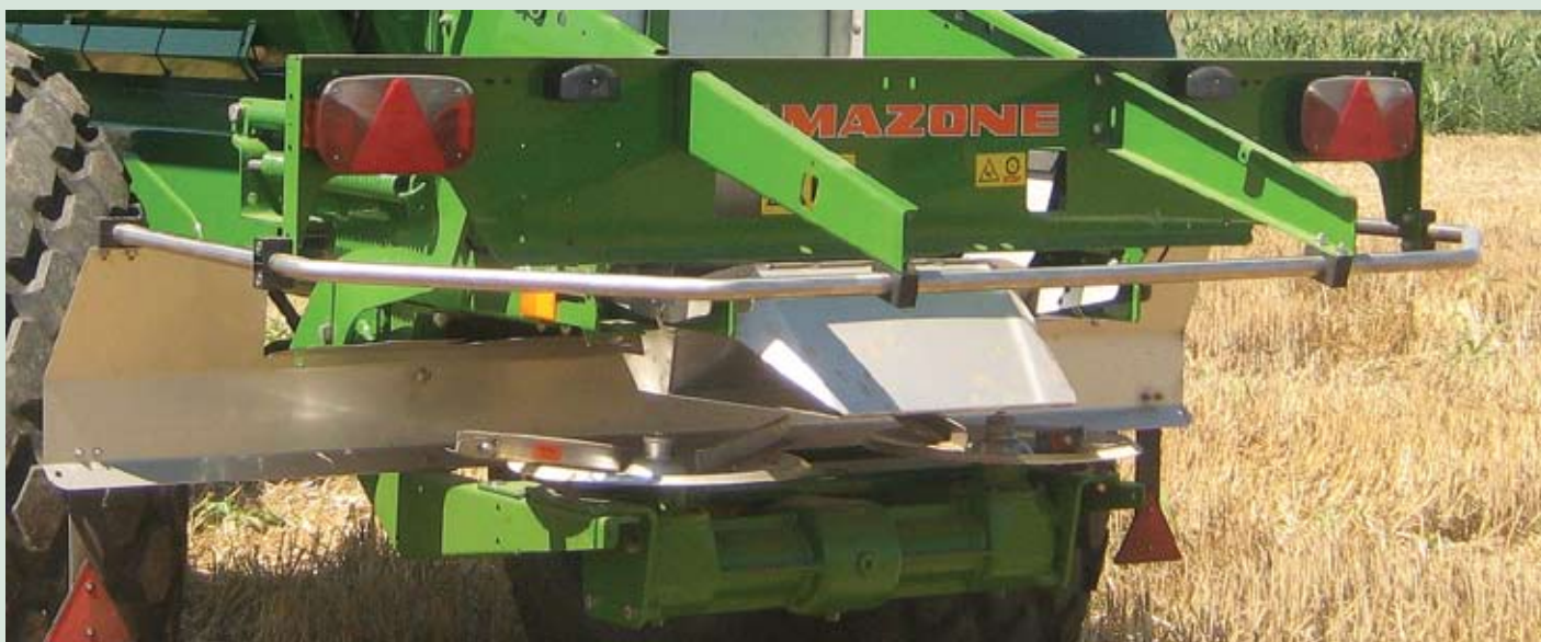
Gnojivo ispada na samo središte diska gdje je brzina okretanja lopatica najmanja
