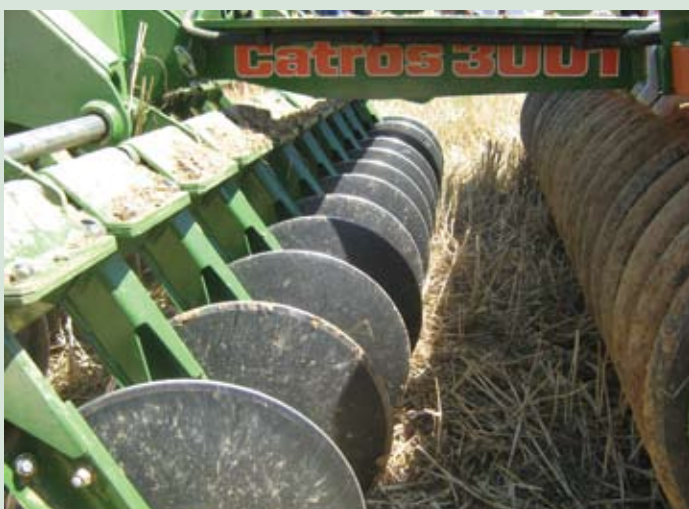
Promjer diskova je 460 mm, nagib prednjih je 14 stupnjeva, zadnjih 17
