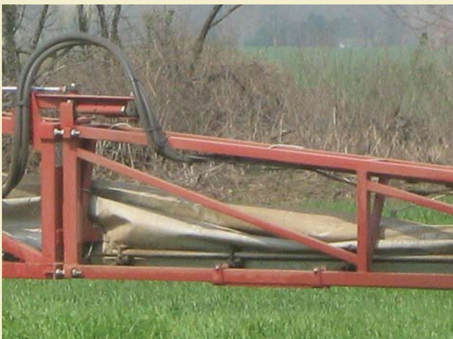
Poslije prskanja vodom pod pritiskom operite metalne dijelove i ponovno lagano premažite uljem
