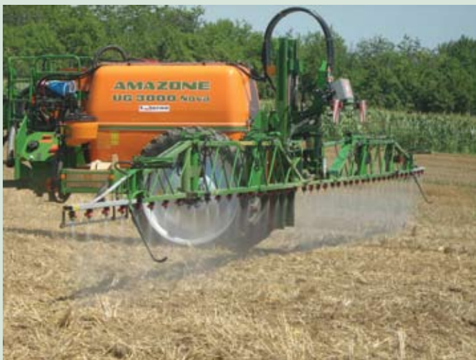
Odlikuju se jednostavnošću rada, grane 12-28 metara nošene, a 18 – 40 metara vučene. Na slici vučena prskalica.
