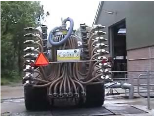
Uporabom ulagača (injektora) neugodni miris smanjuje se od 55 - 85 %
