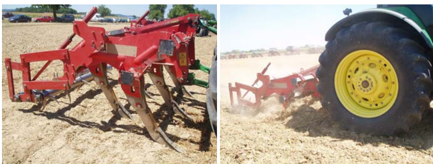
Podrivanjem svake dvije do tri godine, probija se i taban pluga.
