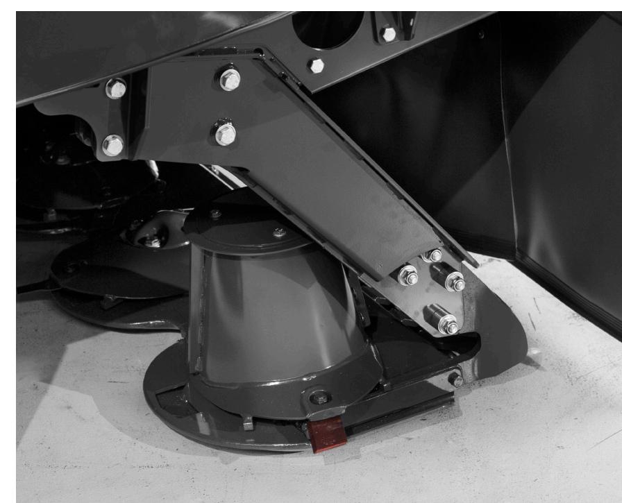
Dizajn kosilice je osmišljen tako da je težište kosilice što je moguće bliže traktoru. Greben kosilice s obje strane ojačan petom, što smanjuje mogućnost oštećenja ležajeva na grebenu.
