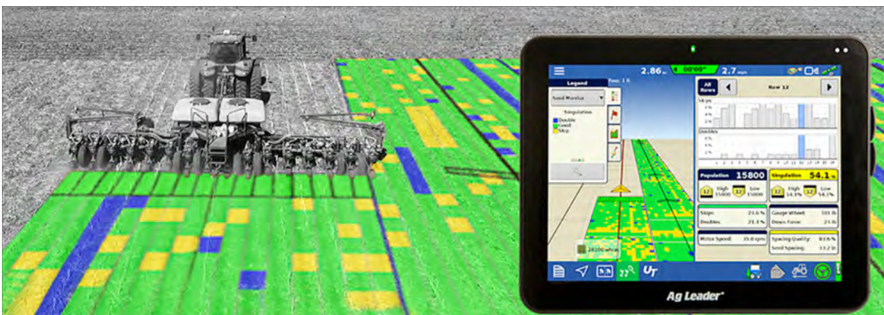
Sijačica može zasebno upravljati pojedinim sekcijama i npr. ovisno o kvaliteti tla aplicirati više / manje sjemena.
