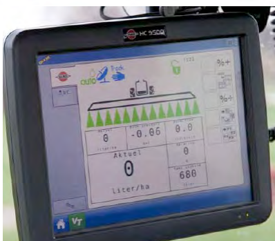
Izgled ISO terminala koji istovremeno obavlja i sekcijku kontrolu prskalice
