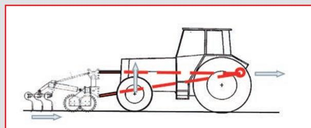
Tačka otpora se nalazi iznad zadnje osovine = „Visokovešano”
