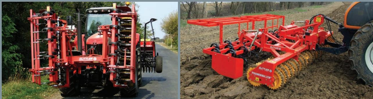
Do 3m radne širine mašine Front poseduju kruti ram, iznad toga su hidraulično sklopljivi, stoga svi Front setvospremači se mogu transportovati i na uzanim putevima.
