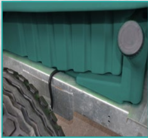
Rezervoar za pranje sistema Circuit washing tank
