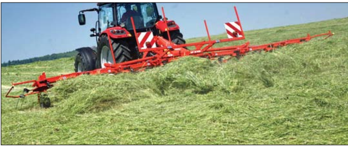
Mali promjer rotora za izvanrednu kvalitetu pokošene trave i brzo sušenje - rotor pokreću DIGIDRIVE spojke - velikog kapaciteta rotora mjenjačem pa ne zahtijeva održavanje
