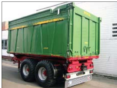
Tandem – iznimno jak višestupanjski kiper cilindar Platforma veličine 5150 x 2480 x 2410 mm
