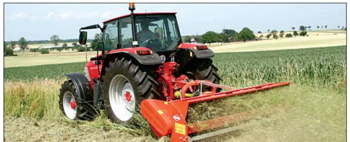
Kuhn BAV dostupan u 1,20 m, 1,50 m i 1,80 m širine, rotacijski su namijenjeni za različite vrste zelenih površina.
