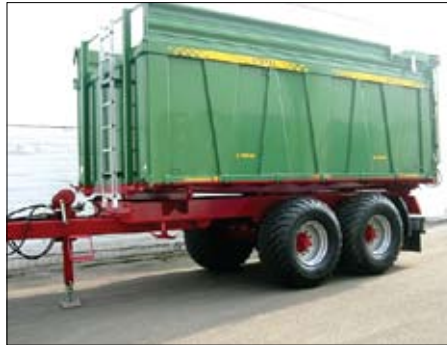
Tandem DREISEITENKIPPER X-Treme verzija prikolica, one s dvije osovine, posjeduju iznimno jak višestupanjski kiper cilindar.
