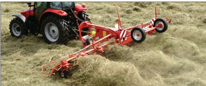
Kuhn GF-8501 ima zglobnu šasiju zbog adaptacije rada na neravnom terenu. Tu su i MEGABALLON kotači na središnjem rotoru
