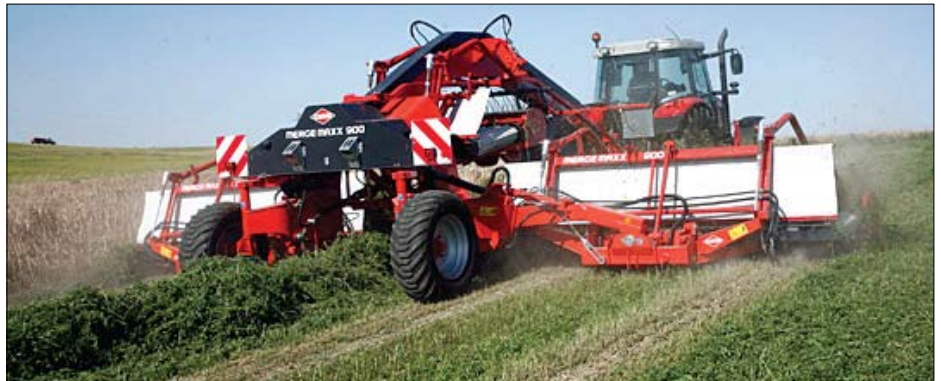
Kuhn MERGEMAXX900 idealan koncept za grupiranje velike količine stočne hrane s maksimalno očuvanje njegove prehrabene kvalitete - hrana prikupljanja i kretanja, bez dodira s tlom
