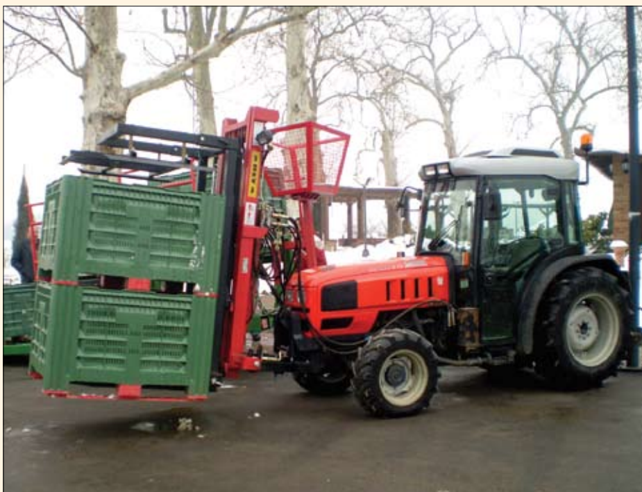
Voćarski Same traktor s OLT-ovim prednjim viljuškarom kao priključkom za transport paleta
