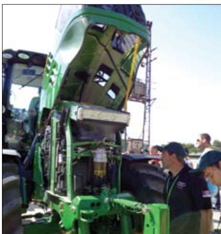
Filtri zraka motora, zraka kabine i re-cirkulacijski filtri kontroliraju se i mijenjaju bez uporabe alata
