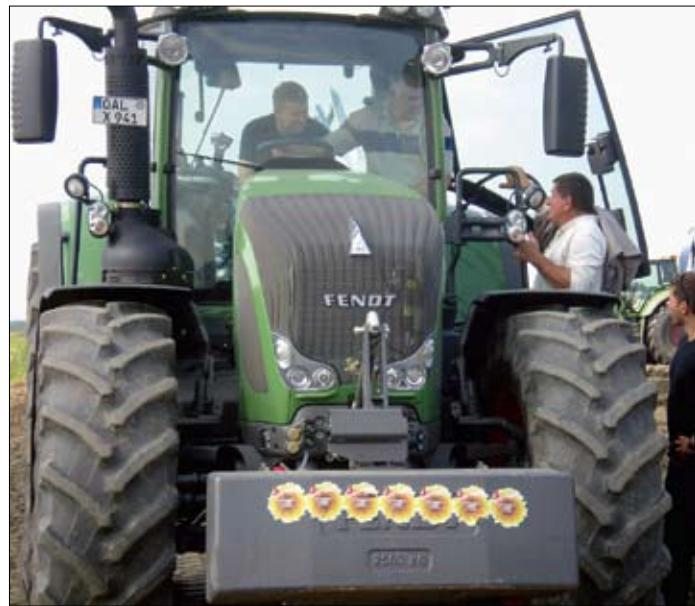
mjenjačem, Raspon brzine kretanja od 20 metara na sat a brzina kretanja po cesti je i do 60 km/h,s tempomatom. Istimemo i prednju gibljivu osovina te prednju hidrauliku u serijskoj opremi. TMS –traktor menadžment sistem je elektronika koja sinkronizira rad mjenjača i motora i također se prodaje u svakom traktoru. Max broj duplo djelujućih utičnica 8 pozadi sa mogućnošću regulacije protoka ulja preko 10,5 inčnog terminala.
