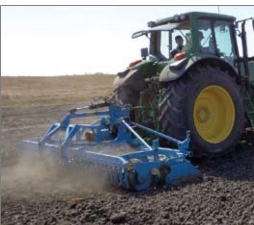
Za ovu rotodrljaču treba traktor snage od 130 konjskih snaga
