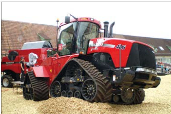
Moguće je savijanje stroja u desno i lijevo do 42° i skoro da ne ostaju tragovi gusjenica
