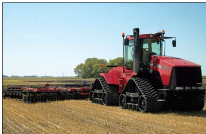
Novi Case IH STX530 traktor vrh je Steiger linija s 530 konjskih snaga proizveden s 15-litarskim Cummins QSX15 motorom
