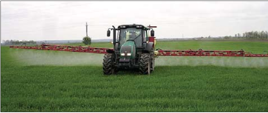
Detalj s probnog prskanja proljetos. Prsalicu nosi Valtra T-serije, t161, snage 125 ks
