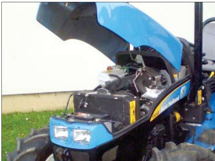
Model T3040 pogonjen je motorom zapremnine 1995 ccm sa turbopunjačem
