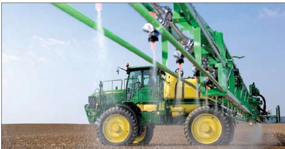
Sprayer pro kontrola sekcija krila na prskalicama i automatsko zatvaranje glavnog ventila pri okretanju šteti skupe proizvode za zaštitu bilja
