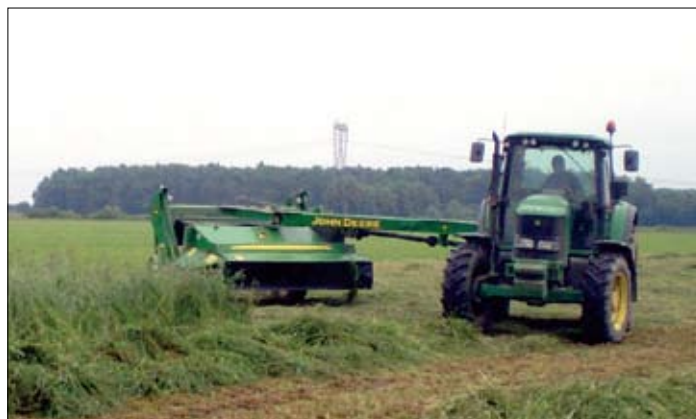
Košnja kosilicom John Deere. Sa svojom centar pivot konstrukcijom, ona se može pomjerati tako da obavlja košenje s lijeve ili desne strane, također i postavka napred i nazad je veoma laka. Odlične karakteristike prilikom okretanja i promjena pravca kretanja
