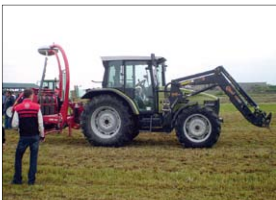
Ovaj Hurliman traktor vuče stroj za omatanje bala a ima i ugrađen prednji utovarivač bala
