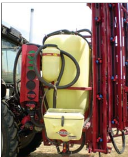
Kapacitet tih tipova prskalica kreće se od 800 do 1200 litara.
