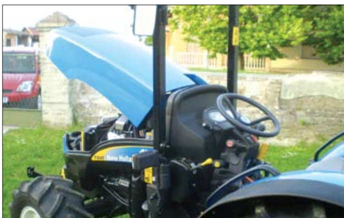
Model T3040 pogonjen je motorom zapremnine 1995 ccm sa turbopunjačem
