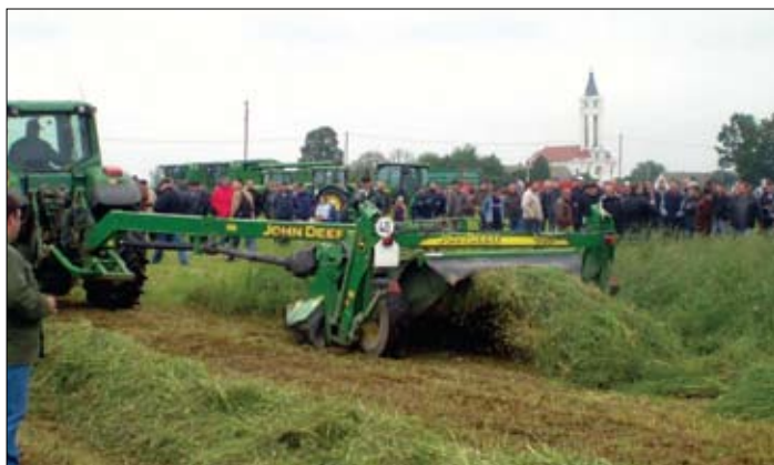
Košnja kosilicom John Deere. Sa svojom centar pivot konstrukcijom, ona se može pomjerati tako da obavlja košenje s lijeve ili desne strane, također i postavka napred i nazad je veoma laka. Odlične karakteristike prilikom okretanja i promjena pravca kretanja
