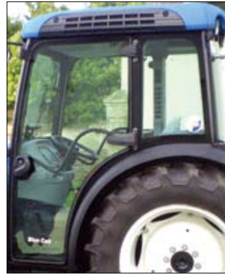
Kabina "Blue Cab" sa nadtlakom i sa još učinkovitijim sustavom filtriranja zraka sa mogućnošću ugradnje karbonskih filtera, koji su posebno učinkoviti u radu sa sredstvima za psikanje
