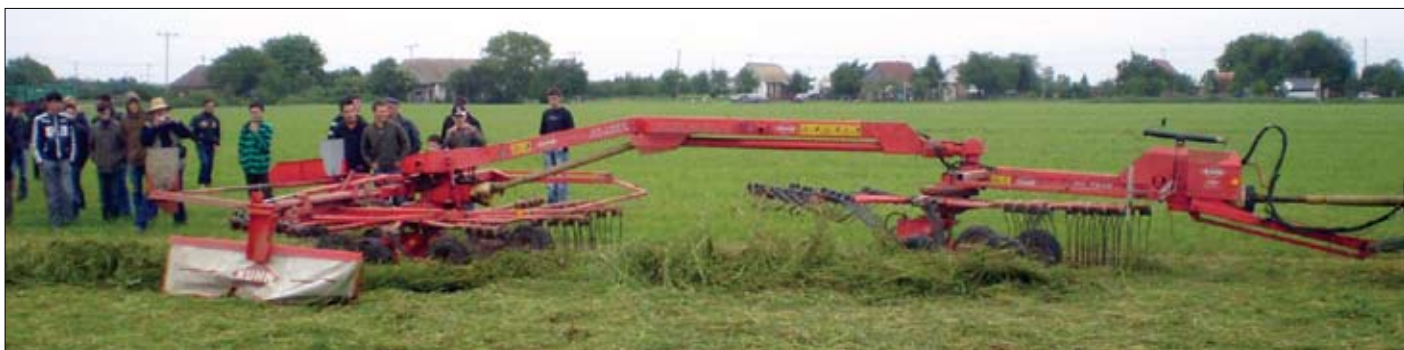
Kuhn prekretač otkosa vučeni radnog zahvata može biti 2,60 - 10,60 m, a radni dijelovi s 2-10 rotora i s po 4-6 ruku po rotoru. Ima DIGIDRIVE pogon rotora te mehaničko ili hidrauličko sklapanje u transportni položaj. Potrebna snaga traktora: od 20 KS, a pogon preko priključnog vratila traktora
