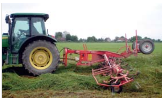
Kuhn vučeni strojevi za sakupljanje otkosa mogu imati jedan ili dva rotora sa radnim zahvatom i do četiri i pol metra. Ima 9-13 ruku po rotoru, 3-4 radna prsta po ruci
