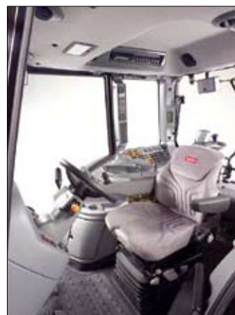
Pogled u unutrašnjost kabine. Kontrolni prekidači i tasteri su smješteni tako da su jednostavni za rukovanje
