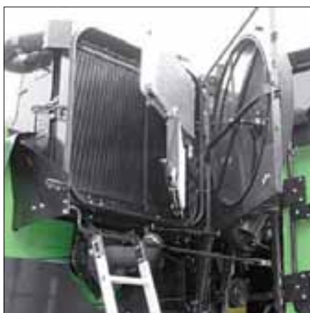
Za lakši pristup rešetka se može otvoriti
