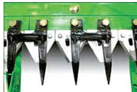
Reciprocno montirane oštrice smanjuju trošenje
