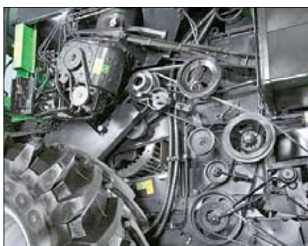
Automatski load-belt osigurava napetost potrebnu za održavanje propusnosti
