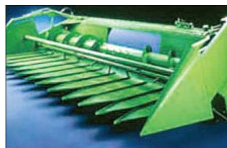
Promjenom košare kombajn se koristi i za žetvu suncokreta
