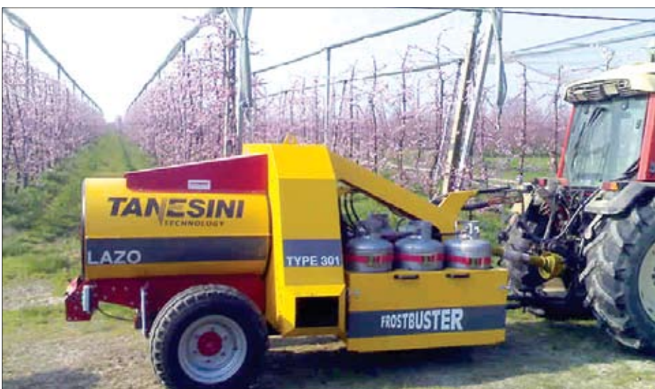
Snažne turbine izbacuju vrući zrak koji pri izlazu iz frostbustera ima temperaturu 80-100 st. C na izlazu iz turbine Frostbuster type 301 talijanskog Tanesini tehnologij.
