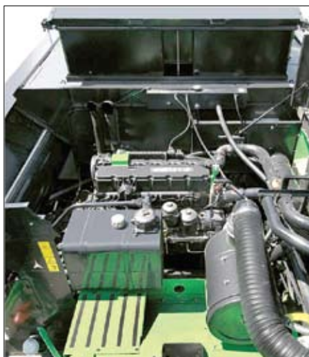
Common-rail sustav u DEUTZ motorima ekstremno visokim tlakovima ubrzgavanja daje optimalnu učinkovitost motora
